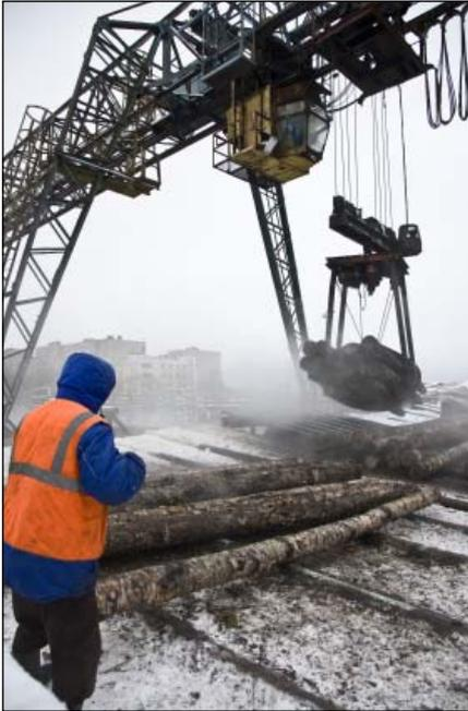
*С лесовозов кругляк поступает на первичную обработку. Специальный кран опускает бревна в «бассейны» с горячей водой, где дерево «варится» для более легкого отделения коры. Затем бревна поступают на наклонную платформу, с которой рабочий с помощью крюка перетаскивает их на конвейер для нарезки. Работа непростая, учитывая, что круглый год проходит на открытом воздухе.*
