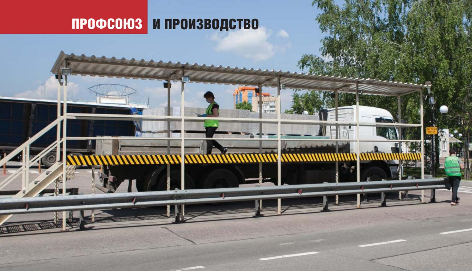
При отгрузке товара важен не только контроль качества, но и проверка накладной: покупатель должен получить именно то, что заказывал. При этом проверяющий стоит на удобном мостике, а не карабкается в кузов грузовика.
